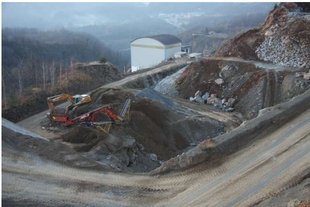
Vista da Nord – Est del piazzale di miniera sul quale sono poi stati rilocalizzati gli impianti per la frantumazione primaria e secondaria; sullo sfondo, è visibile il capannone preesistente, nel quale venivano e vengono svolte le fasi successive del trattamento del minerale di olivina (novembre 2007).
