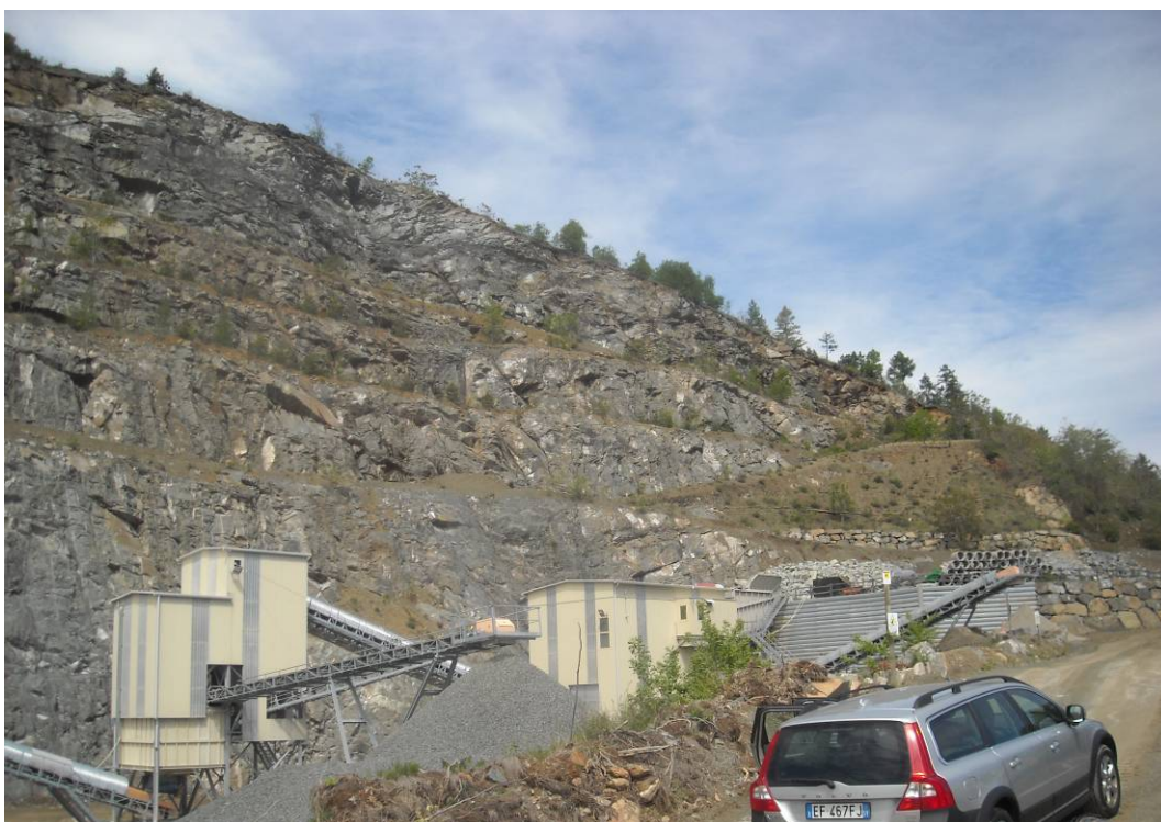
Panoramica del settore settentrionale della miniera, con gli impianti di lavorazione (in primo piano) ed i gradoni dismessi dalla coltivazione mineraria (in secondo piano), in corso di recupero (primavera 2016).
