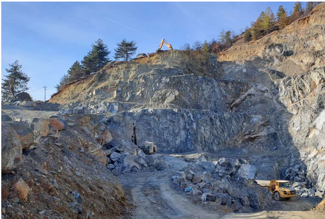
Panoramica del settore sud – occidentale della miniera, interessato dall'avanzamento della coltivazione mineraria, articolata su gradoni sovrapposti (gennaio 2006).
