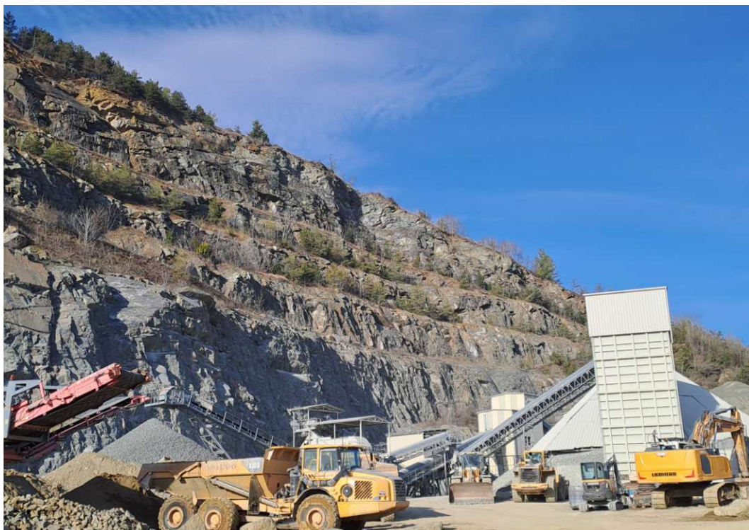
Panoramica del settore centro - settentrionale della miniera, con gli impianti di frantumazione e, in secondo piano, il fronte di scavo a gradoni, già oggetto di recupero ambientale (gennaio 2026).
