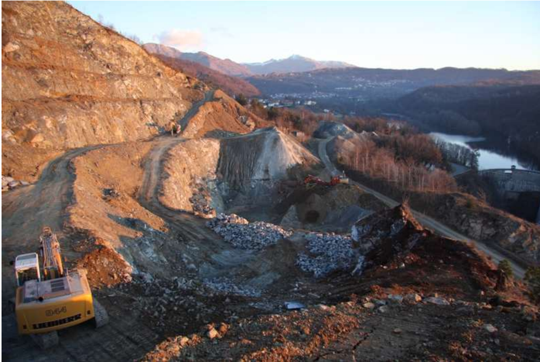
Vista da Sud – Ovest del fronte principale di scavo, nel settore settentrionale del cantiere minerario, e del sottostante piazzale di miniera all'interno del quale sono poi stati rilocalizzati gli impianti per la frantumazione primaria e secondaria del minerale estratto (novembre 2007).
